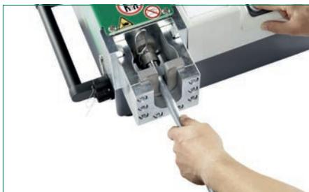
Werkzeugkopf zur Schneidring-Montage mit manueller Druckeinstellung
