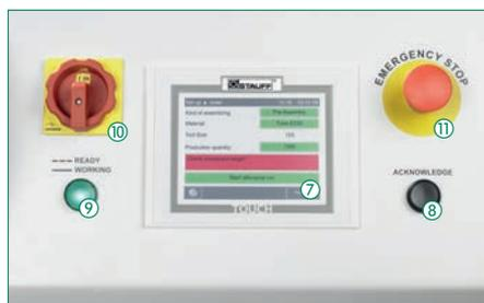
Bedienbereich der Schneidring-Montagemaschine
