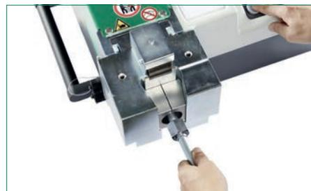
Werkzeugkopf zum 37°-Bördeln mit manueller Druckeinstellung
