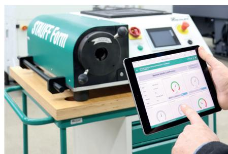
Rohrumformmaschinen des Typs SFO-F-A-A können werkseitig mit einem eingebauten Modul zur direkten Anbindung an eine von STAUFF betriebene Cloud ausgerüstet werden. Realisiert wird diese Lösung mit einer integrierten SIM-Karte, die in sämtlichen Industrierregionen der Welt genutzt werden kann.
