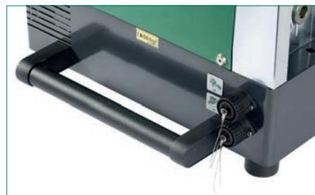
Anschlüsse für Werkzeugkopf zur Schneidring-Montage und für Fußschalter
