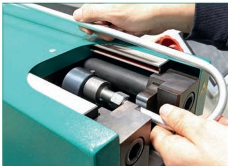
Der Montagekopf unterscheidet sich vom Standardmodell durch eine nach oben verlagerte Aufnahme für den Schneidring Montagestutzen.
