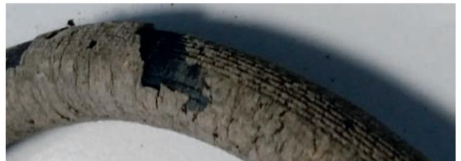
Bremsschlauch mit Ausbrechungen
