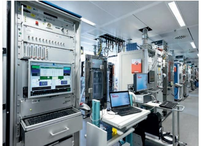
Dauerlaufprüfstände im Hightech-Labor: ENV6 unterstützt mit ihrer hohen Dynamik Leistung und Lebensdauer moderner Bremssysteme.
