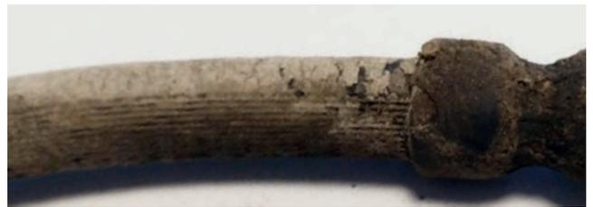
Bremsschlauch mit Ausbrechungen
