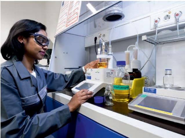
Bosch ENV6 im Labortest: Im Bosch Entwicklungszentrum wird die Bremsflüssigkeit chemischen Prüfungen unterzogen.
