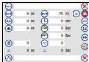
Eingabe von Pressmaß, Korrekturwerten, Haltezeit, Öffnungsdurchmesser, Vorwahlzähler und Pressbacken (automatisch).
