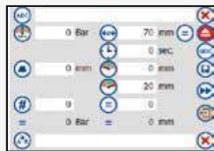
Eingabe von Druck, Haltezeit, Öffnungsdurchmesser, Vorwahlzähler und Pressbacken.
