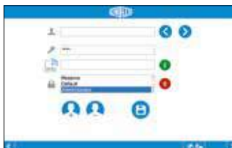
Der RFID-Reader ermöglicht die automatische Anmeldung an der Maschine mit einem RFID-Chip.
