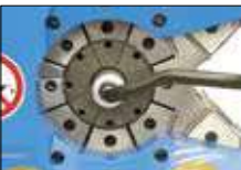
Radiale Zuführbarkeit der Werkstücke auch für 90°-Bögen.
