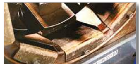
Gleitlager im Zustand nach ca. 900.000 Pressungen
