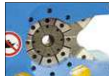
Radiale Zuführbarkeit der Werkstücke auch für 90°-Bögen.
