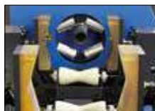
Spanneinheit mit Laufrollen für bis zu 5 Zoll-Schläuche.
